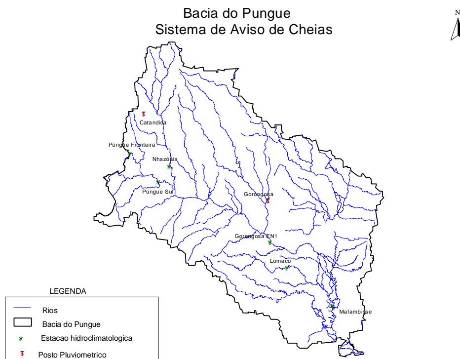
Figura 22: Sistema de Aviso de Cheias da Bacia do Púnguè – Operado pela ARA-Centro
