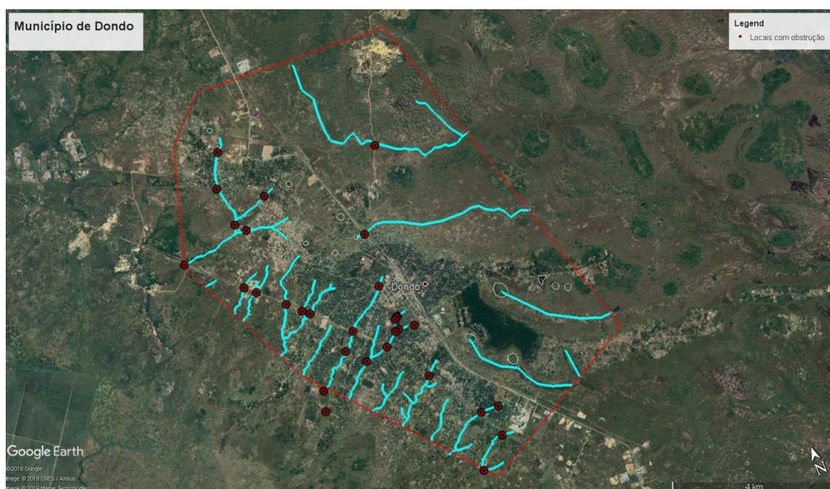
Figura 49: Mapa preliminar – Obstruções nas linhas de drenagem
