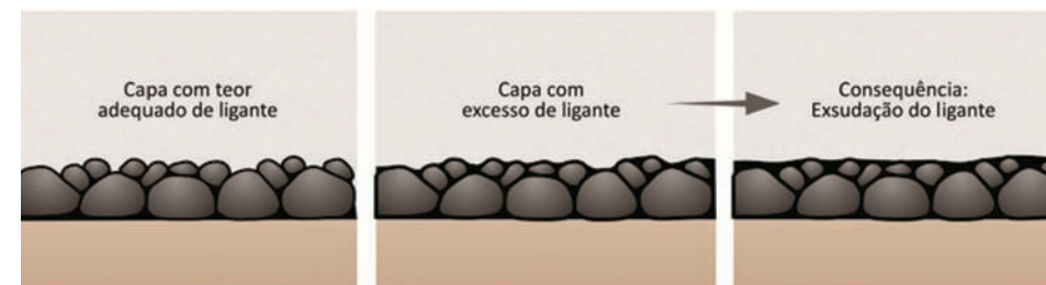
Figura 4-8: Mecanismo da exsudação do ligante no revestimento. Fonte: DER/SP
