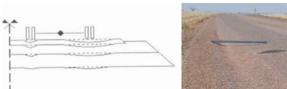
Figura 4-14: Esquema e foto de rodeira com deformação consolidada, revestimento superficial
