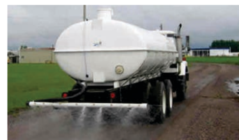
Figura 2-15: Camião aspersor de água
