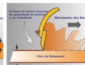
Figura 4-52: Posição da lâmina para mistura. Fonte: Baesso e Gonçalves
