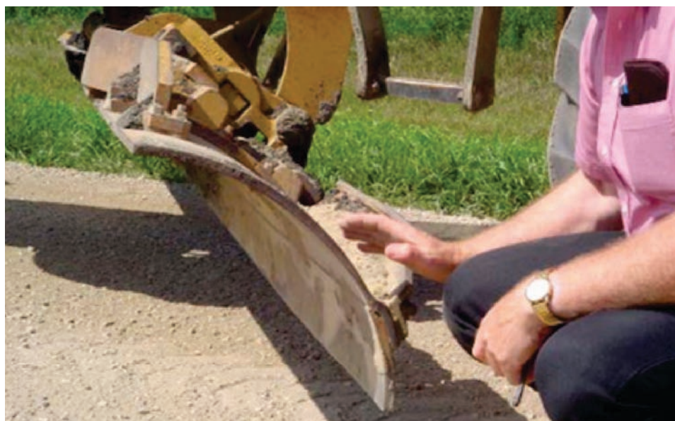
Figura 4-53: Posição da lâmina para nivelamento ligeiro. Fonte: USDT
