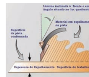
Figura 4-50: Posição da lâmina para espalhamento. Fonte: Baesso e Gonçalves
