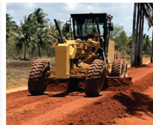
Figura 4-55: Operador a aplicar o princípio das rodas inclinadas
