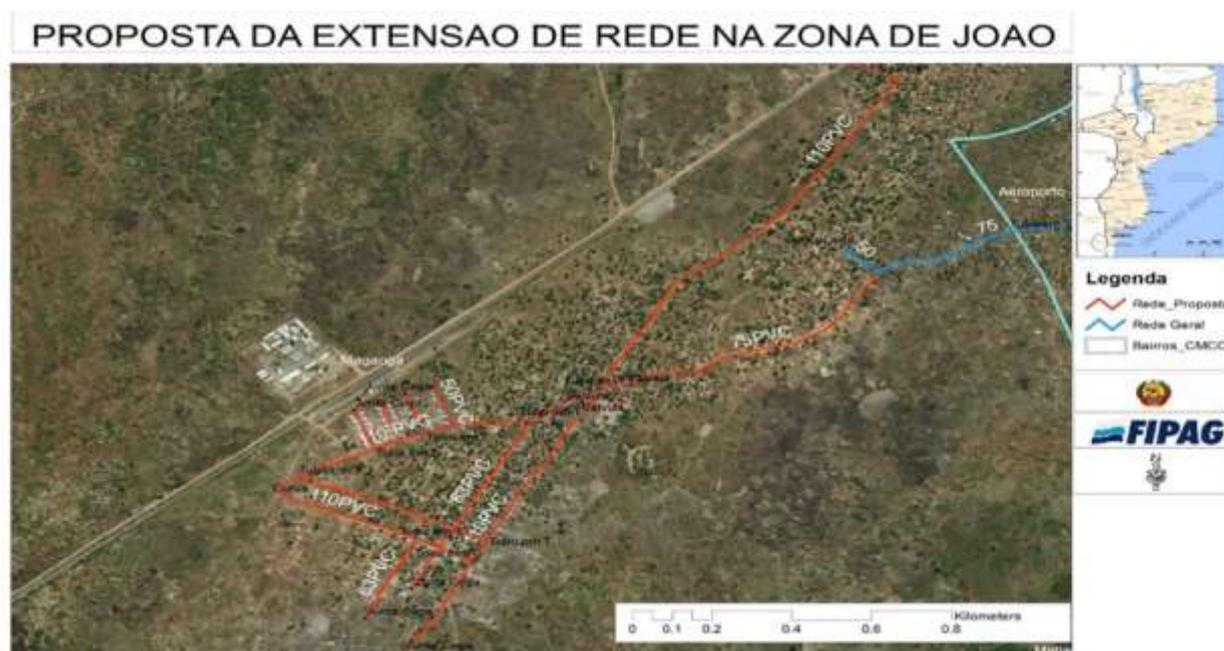
Figura 27 - Planta da expansão da rede de distribuição de água do saa na zona de João
