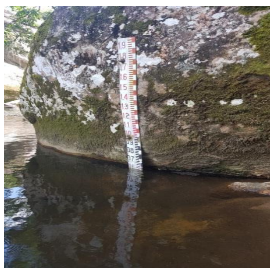
Figura 32: Represa na nascente do rio Licungo, onde se encontra a captação do SAA do Município do Gurúé à esquerda e Escala hidrométrica na represa que alimenta o SAA do Município do Gurúé à direita.
